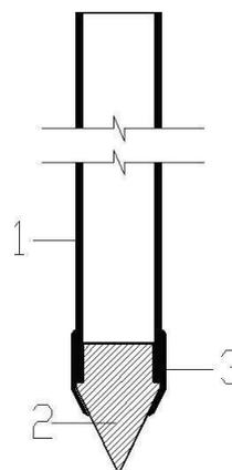
1. 一种建筑地基中成孔的护筒装置,以圆形钢管构成护筒筒身,其特征是:护筒底端带有冲击锥体,冲击锥体的下半部分为直径大于或者等于护筒筒身外径的圆锥体,圆锥体的尖角向下,上半部分为直径小于护筒筒身内径的圆柱体,冲击锥体的上半部分从护筒底端插入到筒身内,在接合处焊接或者铸接或者用螺栓固定为一体。
